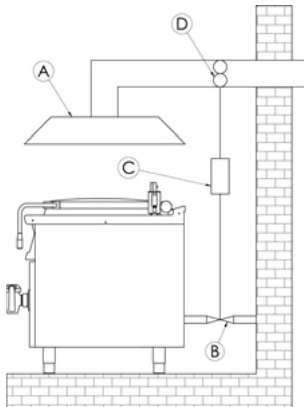
Vyústění digestoře je do samostatného komínového tělesa (A). Odtah spalin zabezpečuje přirozený tah
